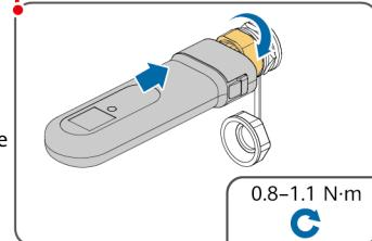
**NB** Koble til en PE-kabel
