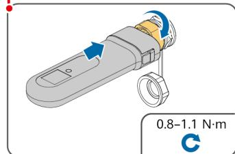
**BG** Свързване на PE кабел
