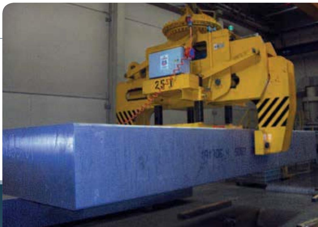
Elektrohydraulische Blockzange zum waagerechten Transport von Aluminiumblöcken.
