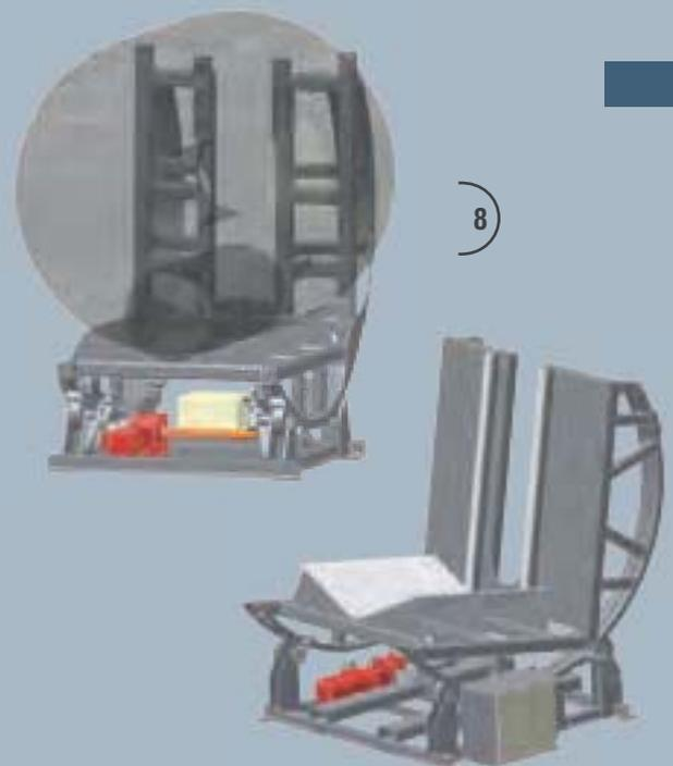
**5-7** Elektrohydraulische Kipptische, geeignet für besonders große Lasten mit ungünstiger, asymmetrischer Schwerpunktlage.
