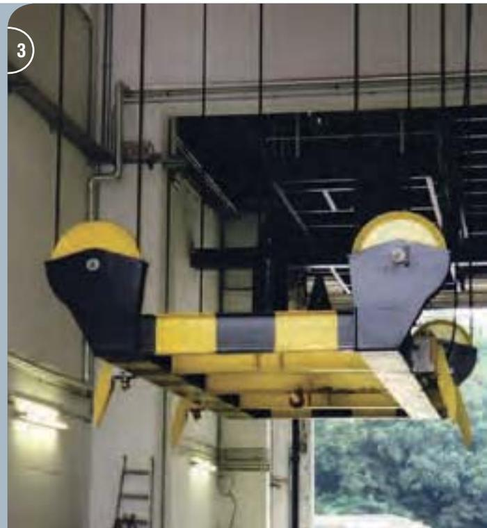
1 Elektromotorischer Containerspreader mit Schwerpunktausgleich in zwei Achsen.
