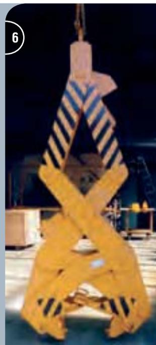
5-6 Mechanische Blockzange mit verstellbarer Greifweite.
