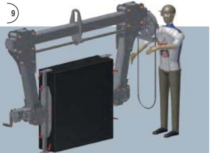
**5-6** Spindelwendegreifer mit Haspelrad zum Öffnen und Schließen, sowie seitlichem Wendeantrieb über Handkurbel.
