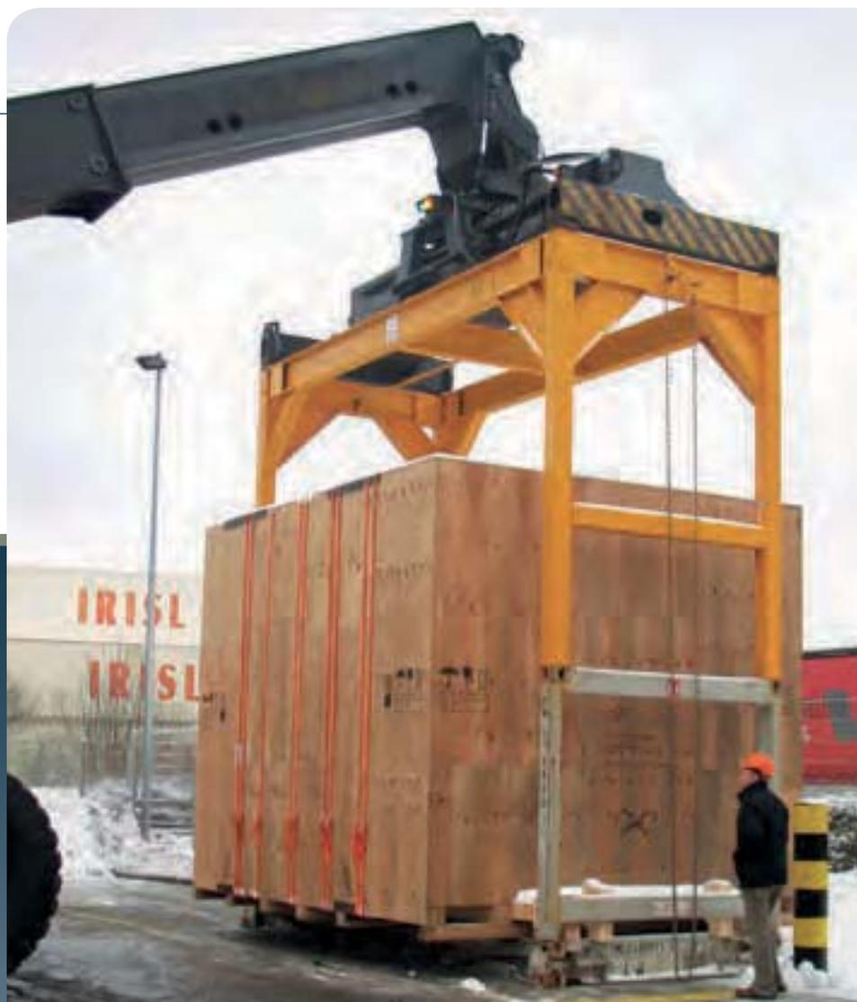
Mechanischer 40'-Überhöhungsrahmen mit manueller Twist-Lock-Verriegelung über Haspelkette.
