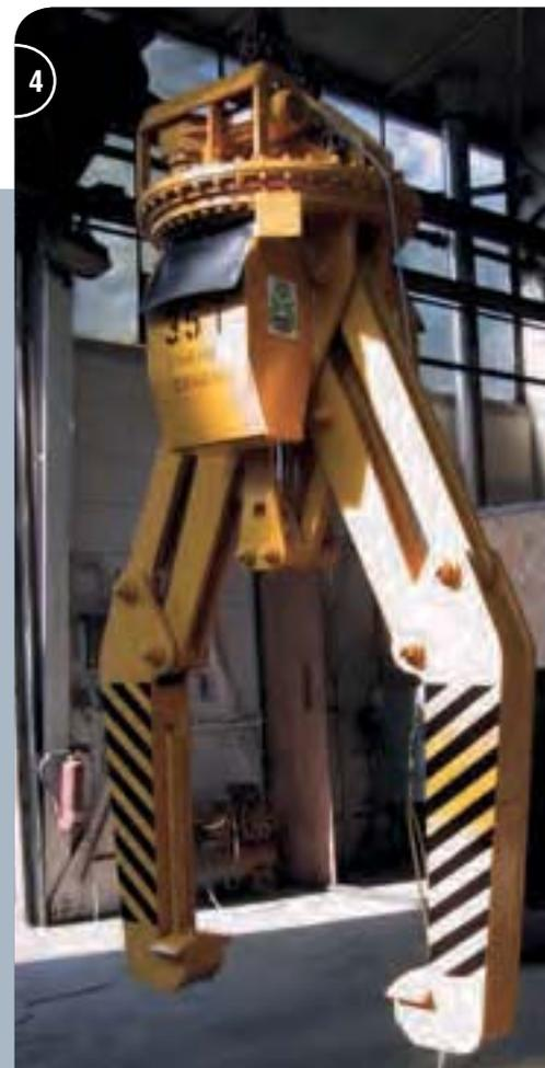
1-2 Teleskopcoilgreifer mit Sondergreifbacken.
