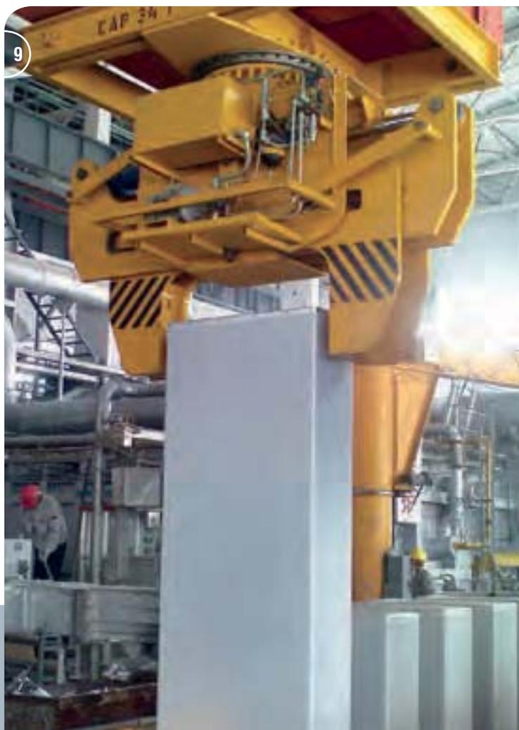
5-9 Elektrohydraulische Blockzange, geeignet zum Aufrichten und Ablegen von Blöcken.
