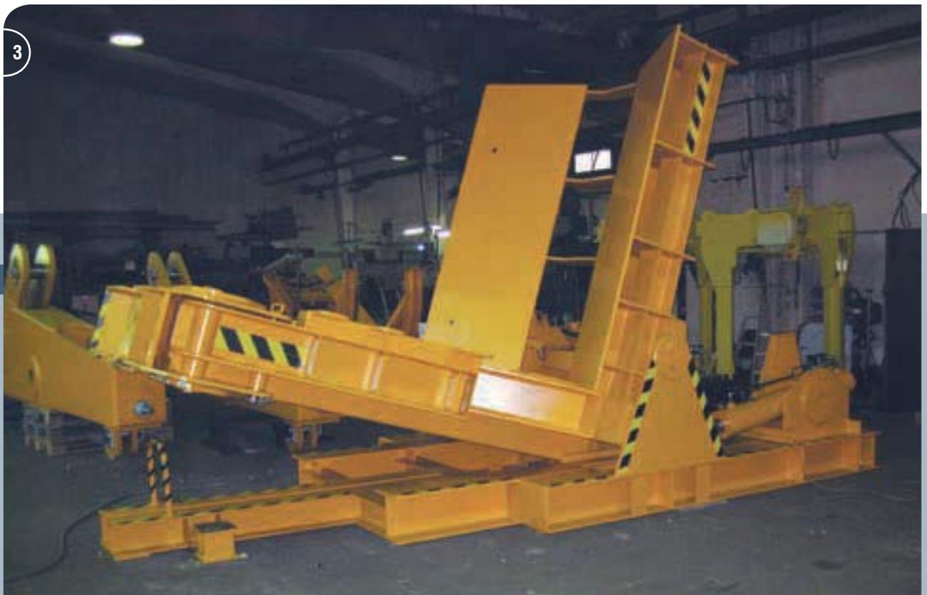
**1-8** Elektrohydraulischer Kipptisch mit ausklappbaren Auslegern für besonders große zylindrische Lasten (hier: Turmsegmente für Windenergieanlagen) mit sehr unterschiedlichen Durchmessern.
