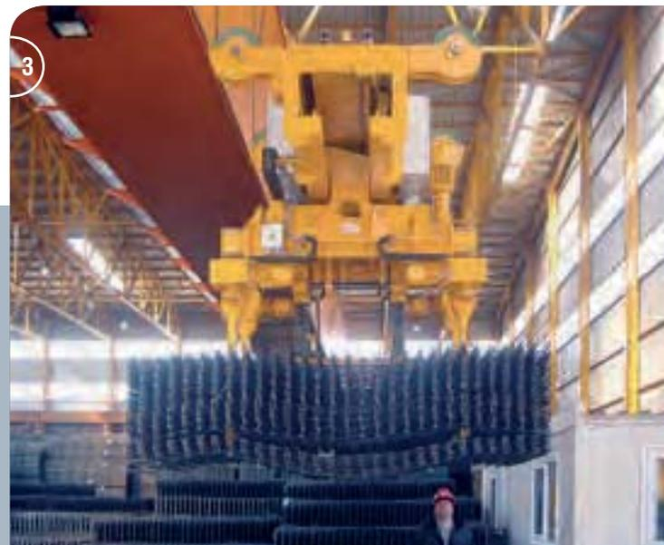
1 Elektrohydraulischer Baustahlmattengreifer, innen greifend.
