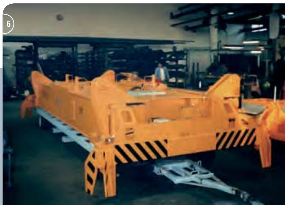
4 Containerspreader elektrohydraulisch teleskopierbar von 20' bis 40'.
