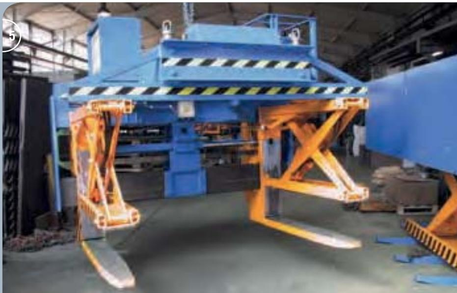
**4-5** Elektrohydraulische Platinenladegabel mit Niederhaltefunktion und Greifweitenverstellung.
