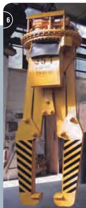
**4-6** Parallelogramm-Coilgreifer zeichnen sich dadurch aus, dass sie einen sehr großen Greifbereich abdecken und seitlich auch bei großer Greifweite gering ausladen, so dass diese Art Greifertyp in engen Räumen bei übereinander gestapelten Coils zum Einsatz kommen kann, z.B. bei der Schiffsbe- und -entladung.
