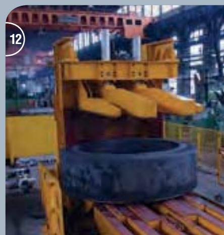
4-12) Wendevorgang mit Schmiedestück Schritt für Schritt.
