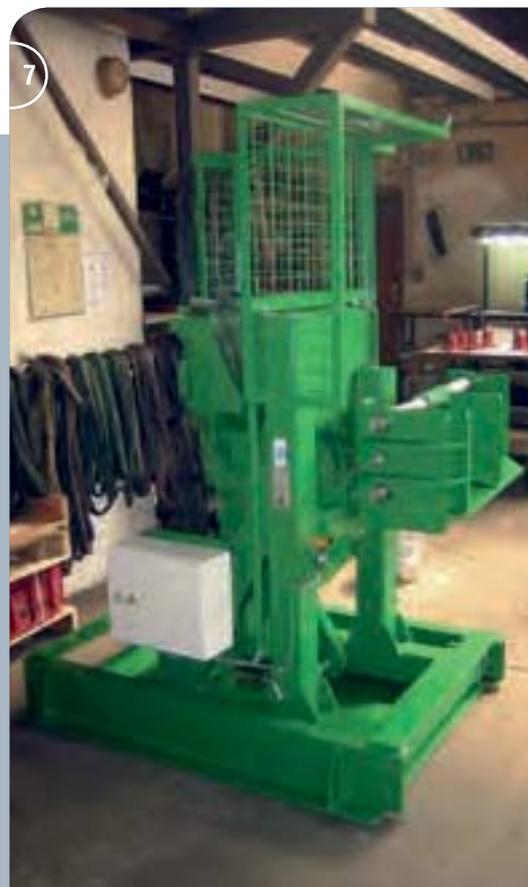
5 Elektrohydraulische Werkzeugwendevorrichtung für 20t Presswerkzeuge.
