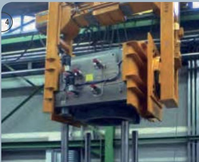
**2-3** Elektromotorische Wendevorrichtung zum Drehen von 12m langen Presswerkzeugen.
