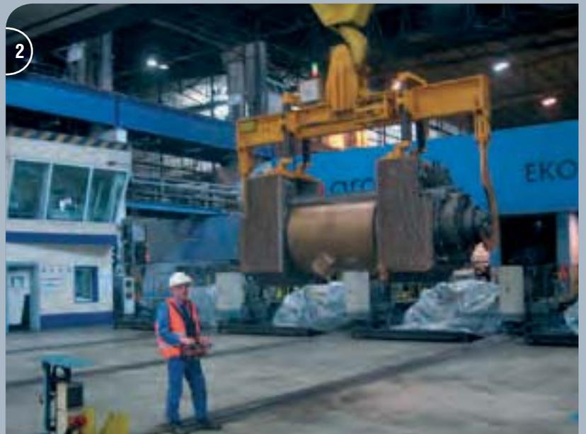
1-2 Elektromotorische Stützwälzentransporttraverse zum Greifen von Stützwälzen mit Baustücken.
