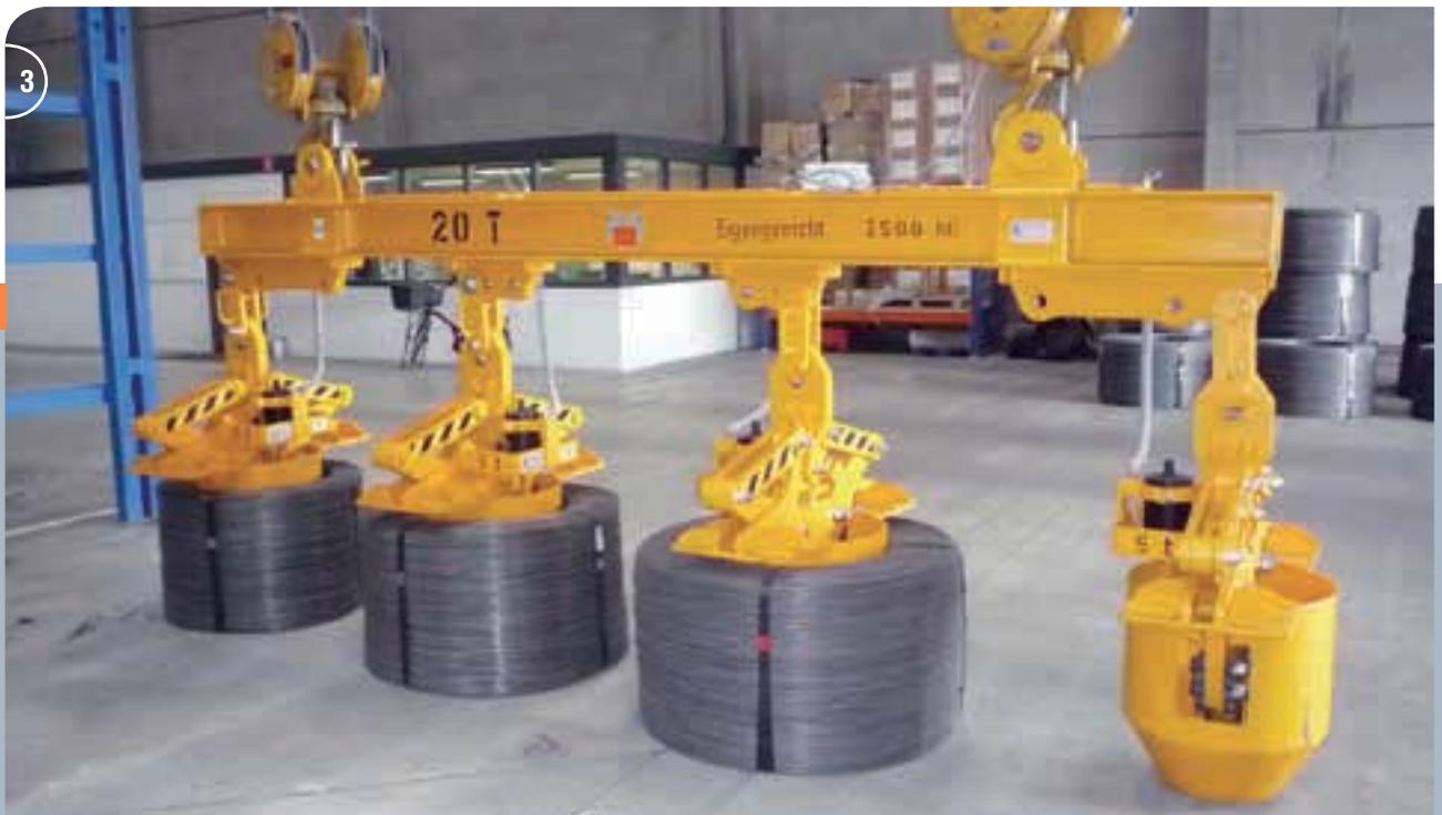
**1** Drahtcoilinnenzangen in 2-facher Anordnung mit verstellbarem Abstand.
