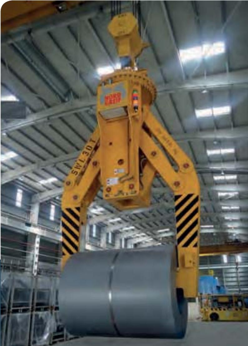
Elektro-hydraulischer Parallelogramm Coilgreifer
