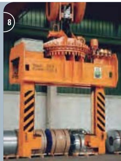
**3-5** Teleskopcoilgreifer mit Drehwerk im Einsatz.
