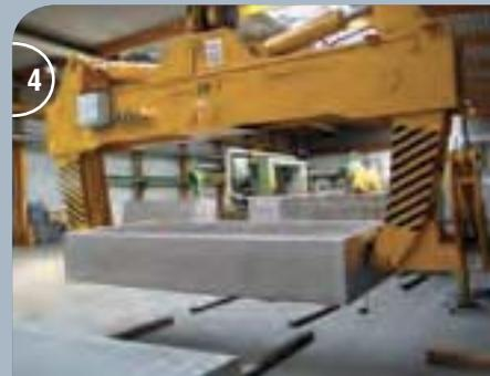
**1-4** Elektrohydraulische Wendezange mit hydraulischem Wendeantrieb.
