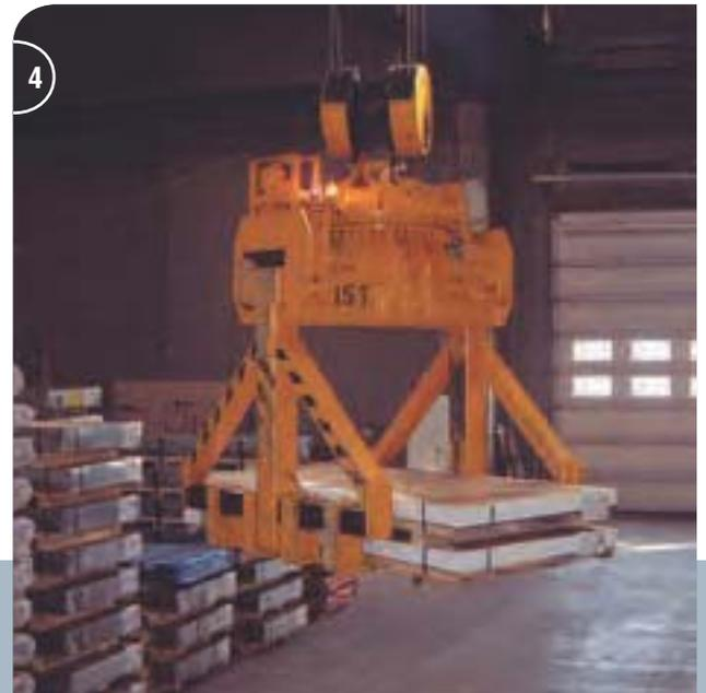
1-2 Elektromotorischer Teleskop-Blechpaketgreifer mit feststehenden Greiferfüßen und mit zwei zusätzlichen ausfahrbaren Greiferfüßen, wobei die äußeren einzeln ausfahrbar sind. Die Steuerung erfolgt über SPS, die einzelnen Fußstellungen können wahlweise programmiert und automatisch aus- und eingefahren werden.
