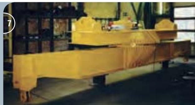
**1-2** Auslegertraverse mit manuell verstellbarer Greifweite in zwei Achsen.
