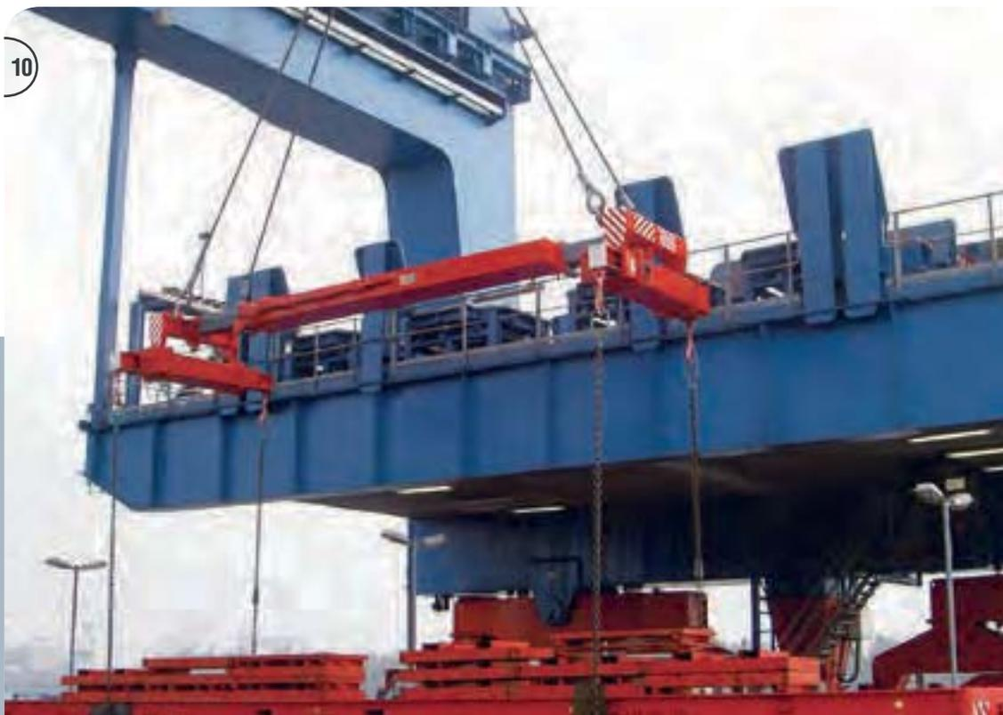
8 Elektromotorische Teleskoptraverse mit Zahnstangenantrieb.
