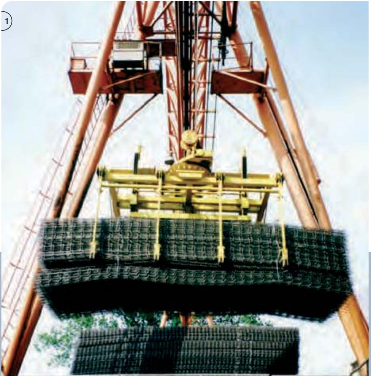
1 Baustahlmattengreifer, Öffnen und Schließen mechanisch,
