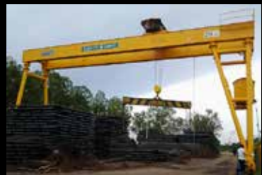
เครนไฟฟ้าขาสูงสองข้าง แบบคานคู่ Gantry Crane : Double Girder
