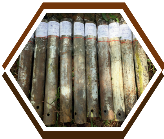
การเก็บตัวอย่างดินด้วยกระบอกบาง (Thin Wall Tube หรือ Shelby Tube)
