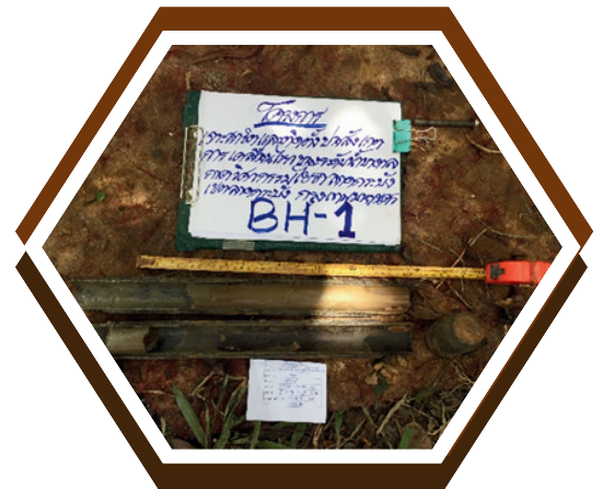
การเก็บตัวอย่างดินด้วยกระบอกแบบผ่า (Split Spoon)
