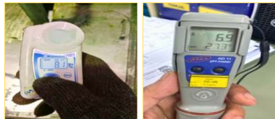
ตรวจสอบความเข้มข้นของน้ำ และค่า PH เพื่อไม่ให้ส่งผลต่อคุณภาพการผลิต
