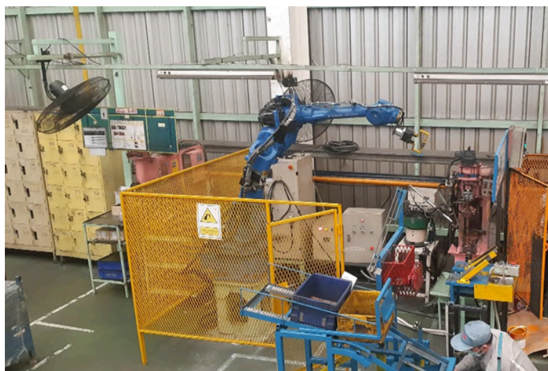
การทำงานของ Semi Auto spot nut weld
