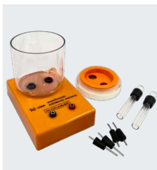
รหัส 21026 370.-/ชุด ชุดสาธิตการแยกน้ำด้วยไฟฟ้า Electrolysis Apparatus
