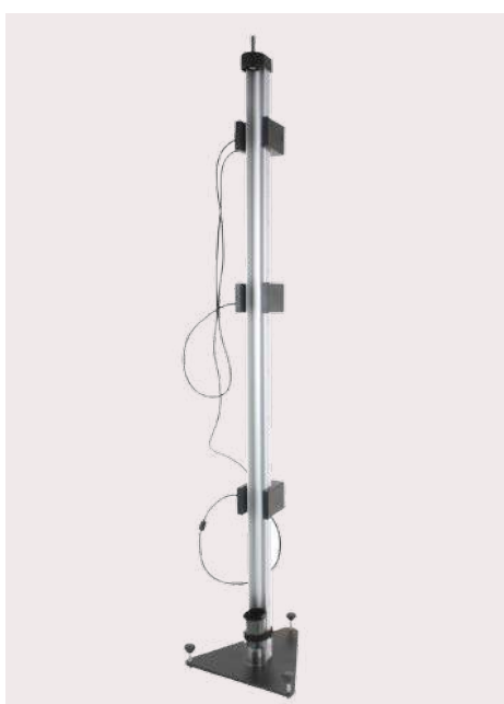
รหัส 29265 25,000.- / ชุด แอร์แทรค 2 เมตร และ Blower พร้อมดิจิตอลไทม์เมอร์ Airtrack 2 m and Blower with digital timer ใช้สำหรับศึกษาเกี่ยวกับการเคลื่อนที่ของ วัตถุโมเมนตัม และการชน ชุดรางติดสเกล ยาว 200 ซม. มี Blower และดิจิตอลไทม์- เมอร์พร้อมไฟโตเกจ
