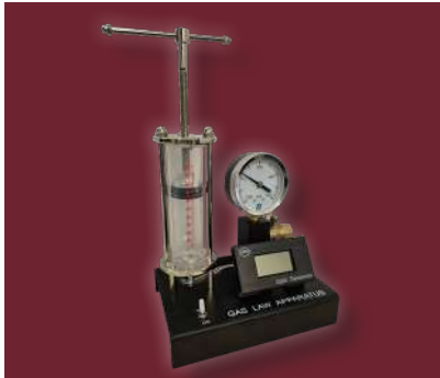
ชุดกฎของบอยล์พร้อมเกจแรงดันและอุณหภูมิ Boyle's Law Apparatus with Pressure and temperature gauge.
