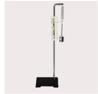
รหัส 21534 1,800.- / ชุด ชุดทดลองกฎของฮุก Hook's Law Demonstrator ใช้ศึกษาเกี่ยวกับกฎของฮุกโดยสังเกตระยะ ยืดของสปริง แรงที่ใช้ยืดสปริงรับน้ำหนักได้ สูงสุด 50 กรัม ขนาดอุปกรณ์โดยรวม 100x150x520 มม.
