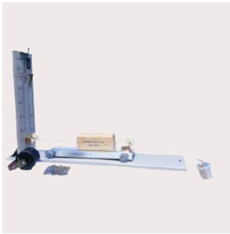
รหัส 21335 4,100.- / ชุด ชุดทดลองแรงเสียดทาน Friction Measuring Apparatus ใช้ทดลองเรื่องแรงเสียดทาน แรงเสียดทาน ที่มีผลต่อการเคลื่อนที่รวมถึงแรงเสียดทาน สถิตและแรงเสียดทานจลน์
