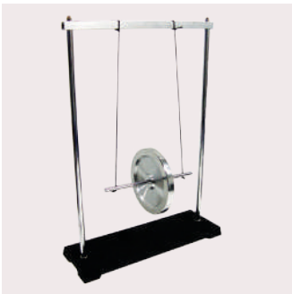
รหัส 21093 1,350.- / ชุด แมกซ์เวลเพนดูลัม Maxwell's Wheel Pendulum ใช้อธิบายการเปลี่ยนแปลงพลังงานจลน์และ พลังงานศักย์ ตามกฎการอนุรักษ์พลังงาน ขนาดอุปกรณ์ 95x280x400 มม.
