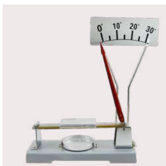
รหัส 21585 1,100.- / ชุด ชุดสาธิตการขยายตัวเชิงเส้นของวัตถุ Linear Expansion Apparatus
