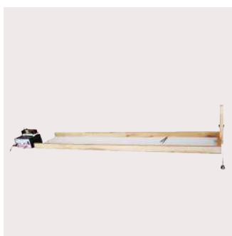
รหัส 29137 5,500.- / ชุด ชุดสาธิตคลื่นนิ่งในเส้นเชือก Standing Wave Apparatus
