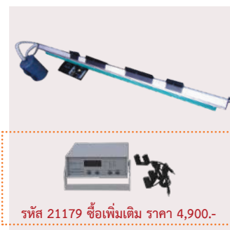
รหัส 21554 20,000.- / ชุด แอร์แทรค 2 เมตร และ Blower Airtrack 2 m and Blower ใช้ศึกษาการเคลื่อนที่ของวัตถุโมเมนตัม และ การชน แอร์แทรคยาว 2 เมตร มีสเกลบอก ระยะทาง 0-200 ซม. พร้อมปั๊มลมใช้กับ ไฟฟ้า 220V
