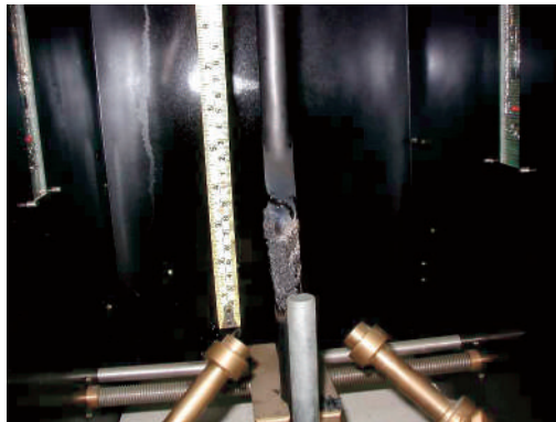
รูปที่ 2.3 การวัดระยะการลามไฟ (การต้านทานเปลวเพลิงระดับต่ำ)
