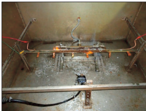
รูปที่ 2.10 การทดสอบ resistance to fire with water spray
