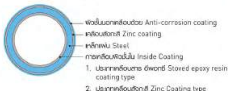
ภาพรูปตัดด้านข้างของท่อร้อยสายไฟฟ้า
