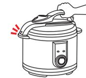
6. วางตัวควบคุมแรงดันบนช่องระบายลมและตรวจสอบด้วยอกแรงดันแบบ POP-UP ให้อยู่ในตำแหน่งที่ถูกต้อง
