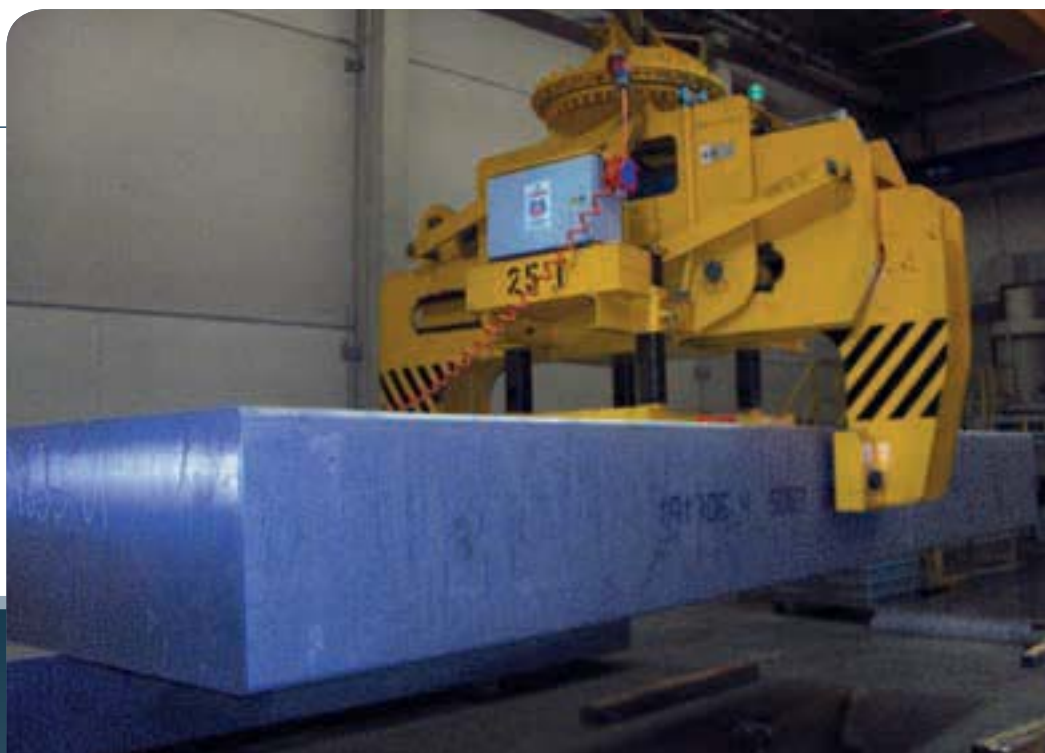
Elektrohydraulische Blockzange zum waagerechten Transport von Aluminiumblöcken. Electrohydraulic Tong for Horizontal Aluminum Slab Handling.
