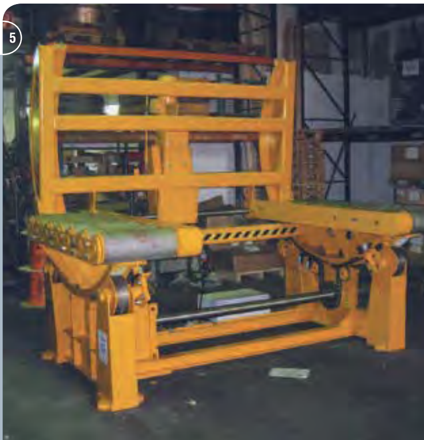
4-6 Elektromotorischer Kipptisch zum Wenden von Aluminiumblöcken um 90°. Electromotive 90° Flipper for Tilting Aluminum Slabs.
