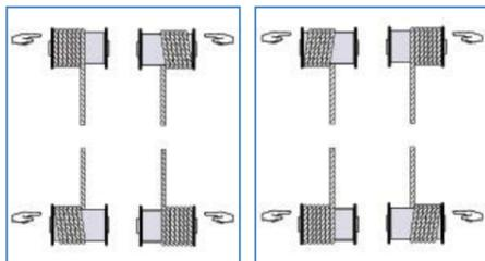
Sie stellen sich an den Festpunkt des Seiles auf der Trommel und folgen mit dem Finger den Windungen des Seiles vom Festpunkt bis zum ablaufenden Strang.
