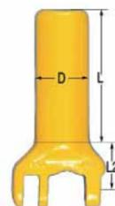
**Achtung** → Bei der mechanischen Bearbeitung des Schaftes darf der mit D\*\* angegebene Durchmesser unter Berücksichtigung der zulässigen Tragfähigkeit nicht unterschritten werden. Die Gewindelänge sollte 1,5 x D min nicht unterschreiten.
