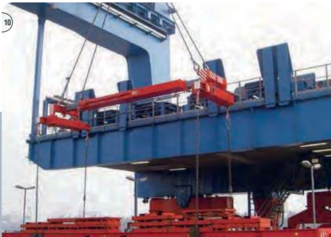
8 Elektromotorische Teleskoptraverse mit Zahnstangenantrieb. Electromotive telescopic beam with rack and pinion drive.
