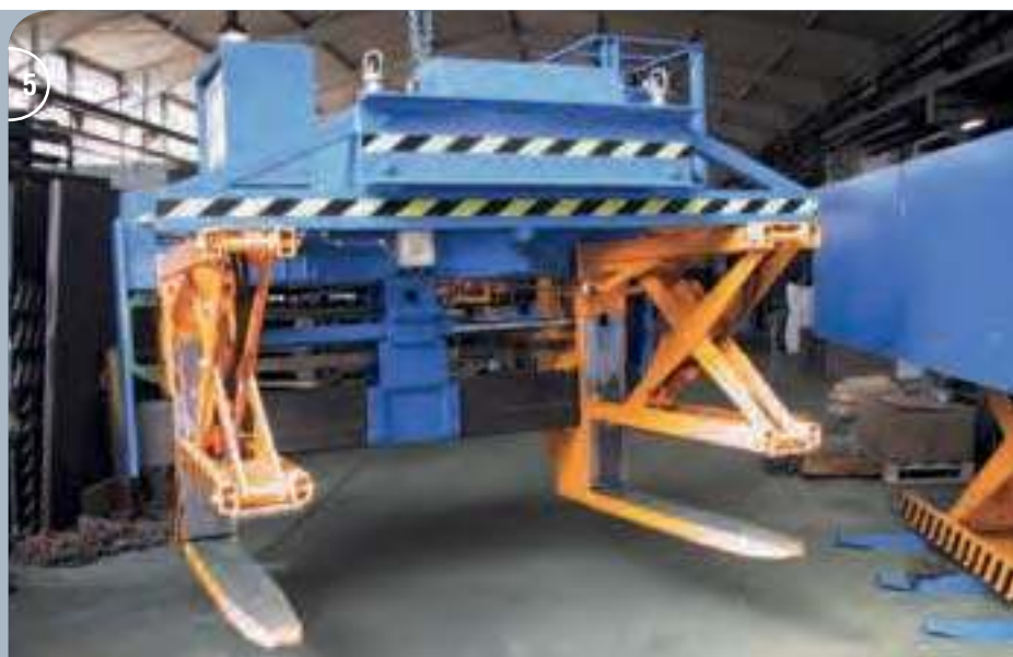
4-5 Elektrohydraulische Platinenladegabel mit Niederhaltefunktion und Greifweitenverstellung. Electrohydraulic board lifts with hold-down function and grab width adjustment.
