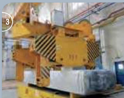
1-4 Elektrohydraulische Doppelblockzangen für Aluminiumblöcke im Einsatz. Ausführung mit elektromotorischem Drehwerk und Seilrollenaufhängung. Electrohydraulic double block tongs for aluminium blocks in Action. Designed with electromotive slewing gear and pulley reeving.
