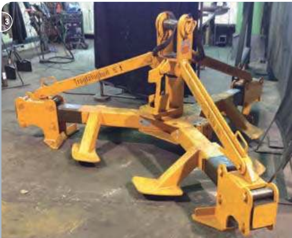
3 Dreiarmlige mechanische Konvektorscheibenzange für den Einsatz in der Glüherei. Arm Mechanical Convector Disc Grab for Use in Annealing Plant.
