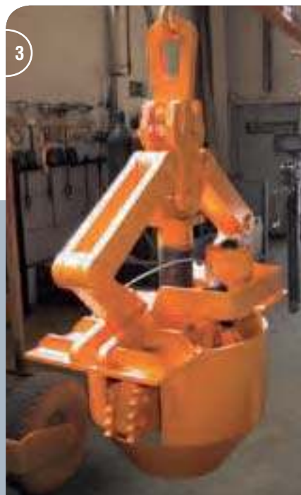
3 Drahtcoilinnenzange mit elektromagnetischer Entriegelung und Einföhrungstrichter. Wire coil inner tongs with electromagnetic release and infeed guide.
