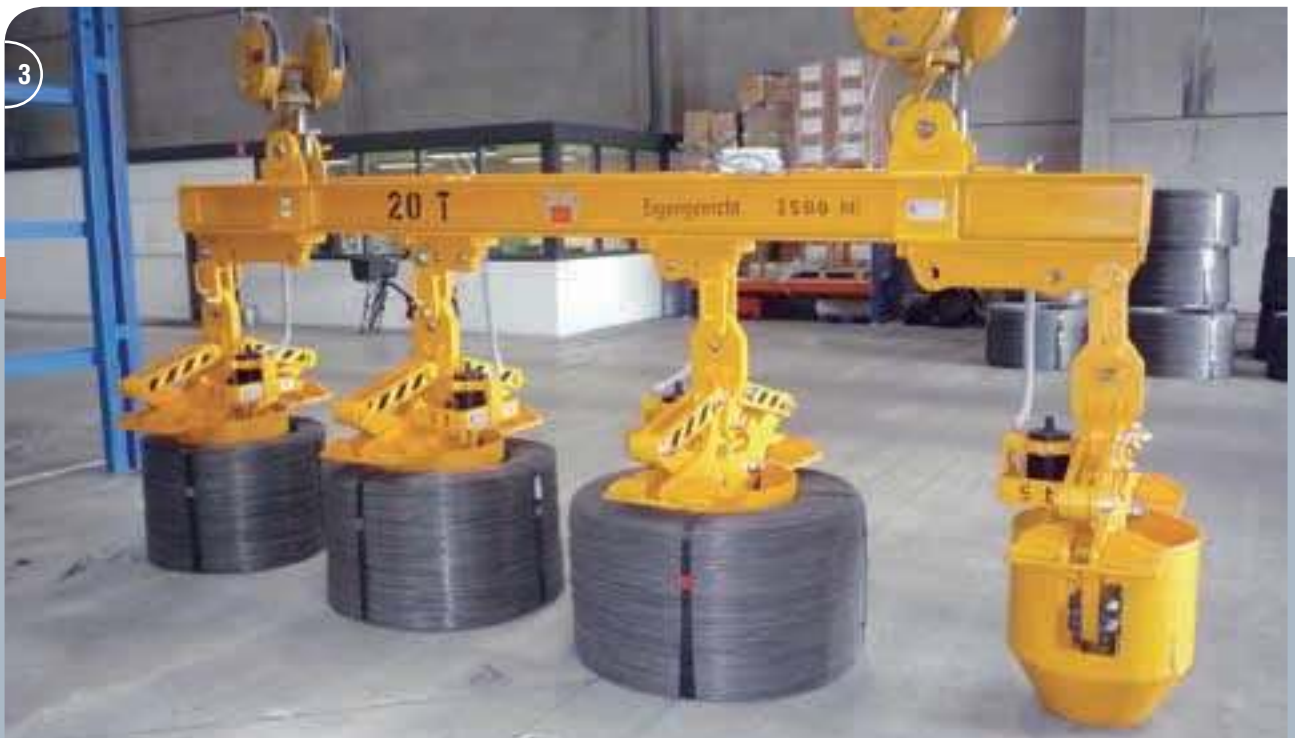
1 Drahtcoilinnenzangen in 2-facher Anordnung mit verstellbarem Abstand. Two Wire Coil Inner Tongs with Adjustable Distance.
