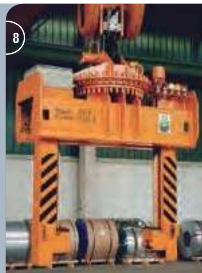
8 Elektromotorischer Teleskopcoilgreifer mit Horizontaldrehwerk, mit Lichtschranken zur Erfassung des Coilinnendurchmesser. Electromotive telescopic coil grab with horizontal slewing gear, with light barriers to detect the coils eye.
