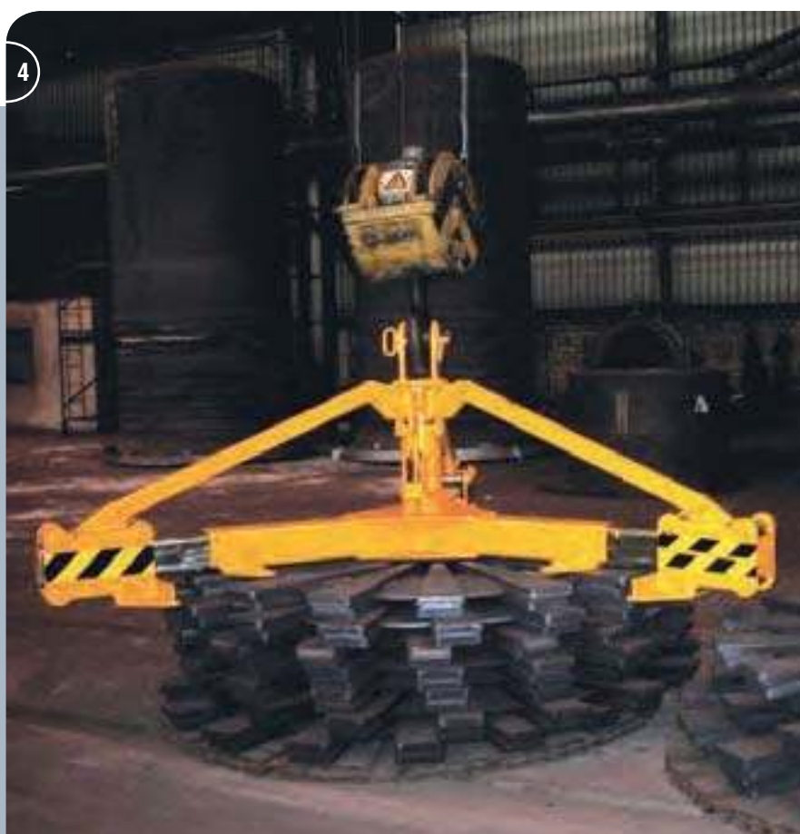
4) Konvektroscheibenzange im Einsatz in einer Glüherei. Annealing Plant with Convector Disc Grab in Action.
