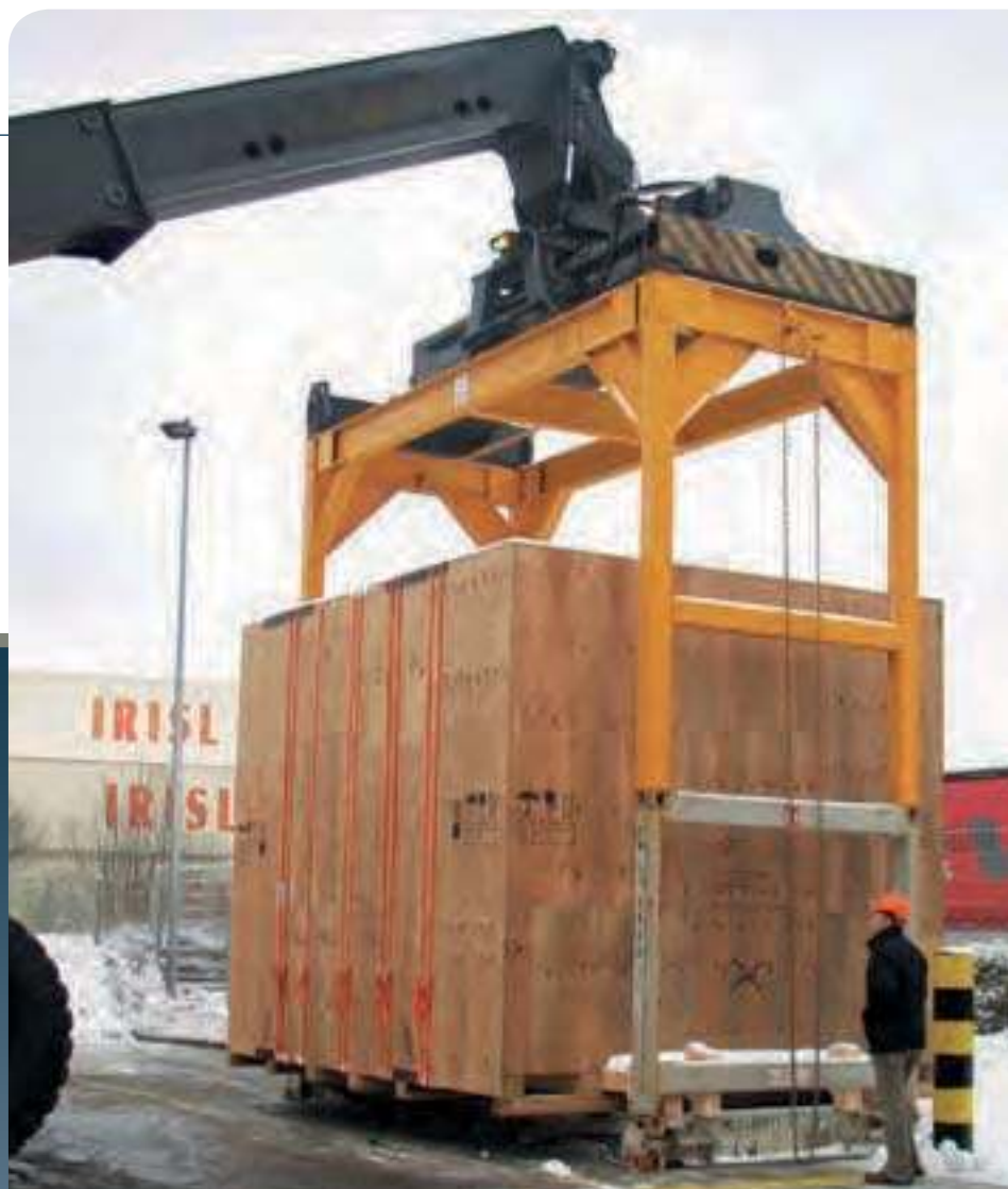
Mechanischer 40'-Überhöhungsrahmen mit manueller Twist-Lock-Verriegelung über Haspelkette. Mechanical 40' banking frames with manual twist-lock bolting above reel chain.
