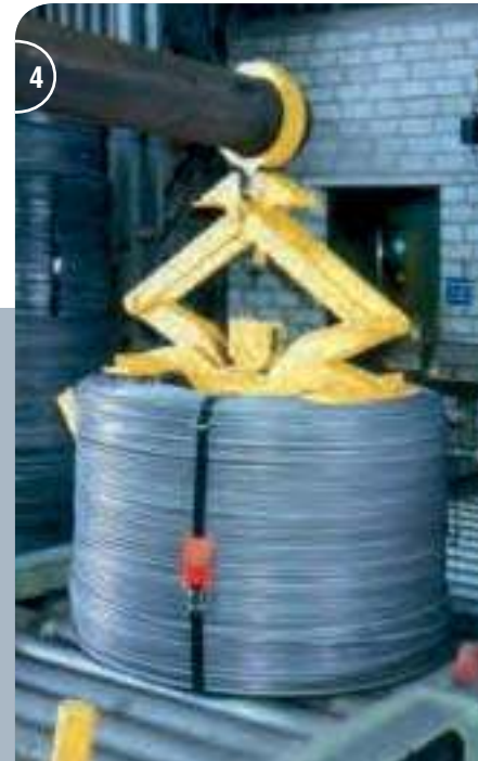
3 Drahtcoilinnenzange mit elektromagnetischer Entriegelung und Einföhrungstrichter. Wire coil inner tongs with electromagnetic release and infeed guide.
