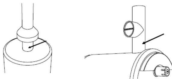
รูปที่ 7.10 ตำแหน่งการวัดไอเสียของหม้อไอน้ำที่เหมาะสม
