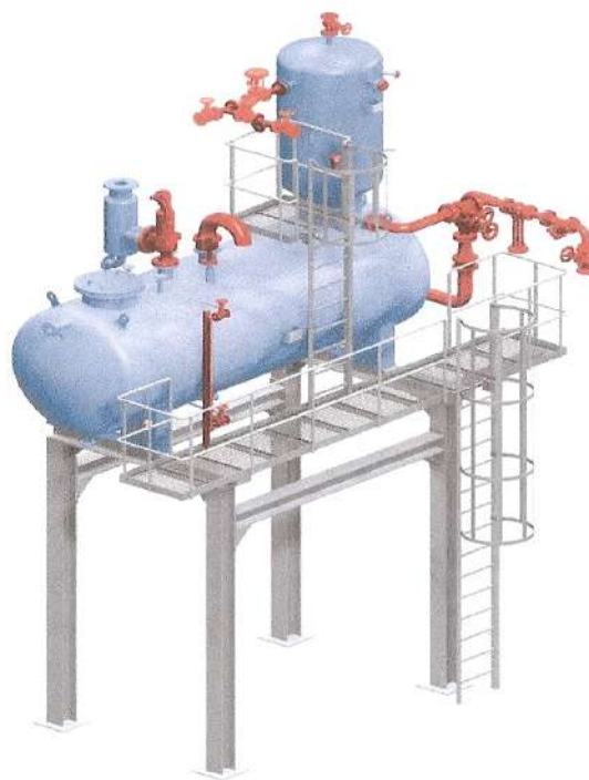
รูปที่ 6.6 ดีแอเรเตอร์ติดตั้งบนถ้ำน้ำเลี้ยง
