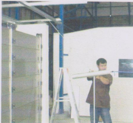
รูปที่ 2.1 การติดตั้งอุปกรณ์สำหรับทดสอบการรับแรงกระแทกที่ระยะความยาว 1.27 เมตรบริเวณรอยต่อแผ่นที่ 4 กับแผ่นที่ 5 ของ ประตูแผ่นกันน้ำ อลูมิเนียม
