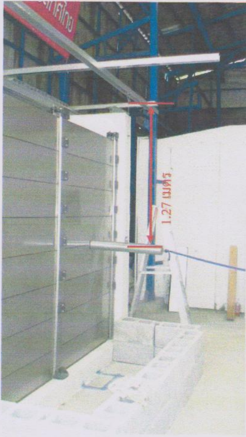
รูปที่ 2.1 การติดตั้งอุปกรณ์สำหรับทดสอบการรับแรงกระแทกที่ระยะความยาว 1.27 เมตรบริเวณรอยต่อแผ่นที่ 4 กับแผ่นที่ 5 ของ ประตูแผ่นกันน้ำ อลูมิเนียม
