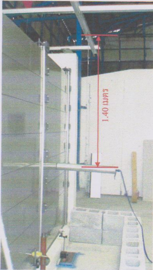
รูปที่ 2.2 การติดตั้งอุปกรณ์สำหรับทดสอบการรับแรงกระแทกที่ระยะความยาว 1.40 เมตรบริเวณกึ่งกลางของแผ่นที่ 4 ของประตูแผ่นกั้นน้ำอลูมิเนียม
