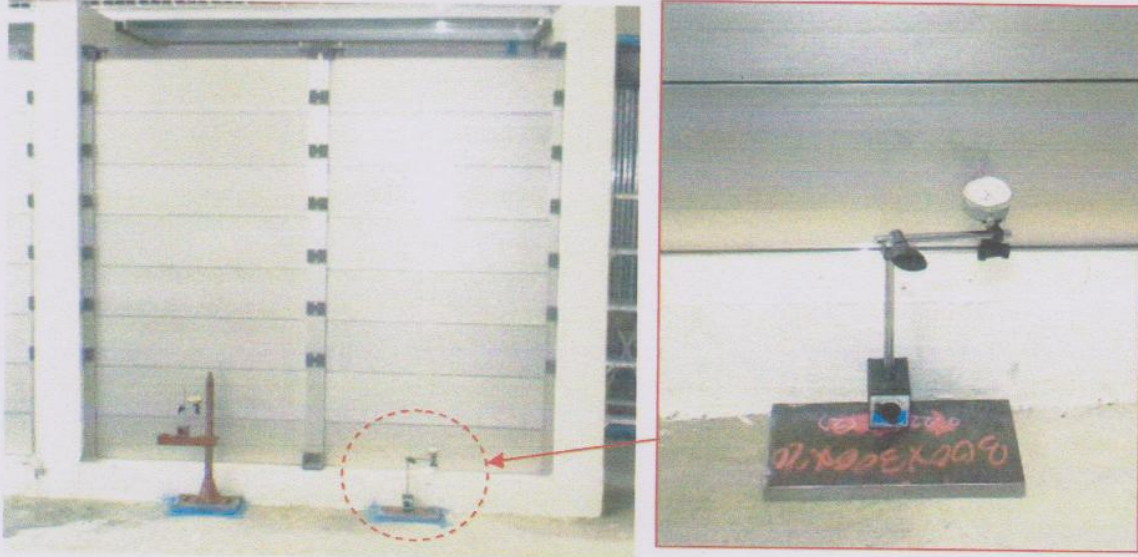
รูปที่ 1.3 การติดตั้ง Dial indicator สำหรับการทดสอบการแอ่นตัวบริเวณจุดที่ 1
