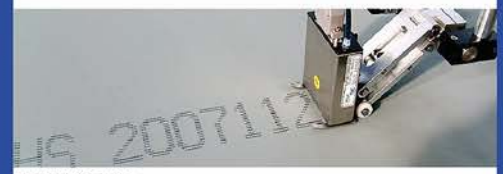
Primer Steel Plate marking
