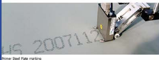
Primer Steel Plate marking
