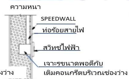
ลักษณะการติดตั้งสวิตช์ไฟฟ้า
