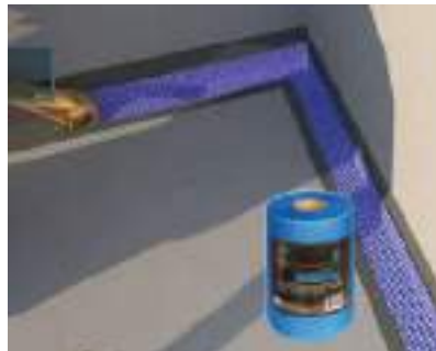
5. หากมีรอยต่อ ให้ติดตาข่ายใยแก้ว RHINOZ ตามแนวรอยต่อ (หากพื้นที่ที่มีการสั่นสะเทือนสูงควรปูทั้งผืน)
