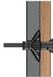
ขันสลกรูหนีปีกพุกขยายแล้วคลายสลกรูออก ติดตั้งวัตถุ พร้อมขันยึดให้แน่น
