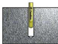
สอดพุกเคมีที่รูเจาะ โดยให้ด้านกลมอยู่ด้านล่าง
