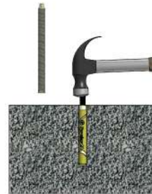
ตอกสตั๊ดพุกเคมีลงจนสุด แล้วค่อยๆทุบสตั๊ดอย่างช้าๆให้น้ำยาผสมกับดีดีและเป็นทรงกลมในรูคอนกรีต และน้ำหนักพุกเคมีจะจับยึดกับแกนพุกเคมีที่อยู่ในจุดที่ทำการตอกพุกเคมีให้
