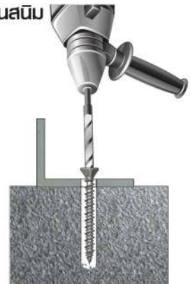
ใช้สกรูคอนกรีตยึดอุปกรณ์ได้เลย โดยไม่ต้องใช้พุก ทำให้ประหยัดเวลา
