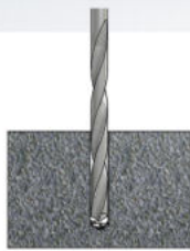
เจาะรูที่พื้น
