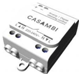
CBU-ASD (IP20) (0-10V / DALI controller) 3.58 x 5.65 x 2.23 cm (48g) • สำหรับโคมไฟ LED Built-in • 0-10V ต่อได้ 4 Driver • DALI ต่อได้ 3 Driver • 7mA (max)
