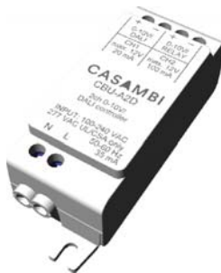
CBU-A2D (IP20) 7.6 x 2.6 x 2.3 cm (40g) (2-Channel 0-10V/DALI Controller) • สำหรับโคมไฟ LED Built-in • 0-10V ต่อได้ 8 Driver • DALI ต่อได้ 6 Driver • 20mA (max)
