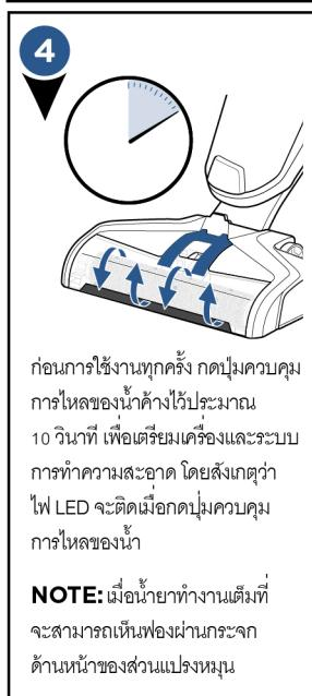
ก่อนการใช้งานทุกครั้ง กดปุ่มควบคุม การให้แสงบนน้ำด้าวไว้ประมาณ 10 วินาที เพื่อเตรียมเครื่องและระบบการทำความสะอาด โดยสังเกตว่าไฟ LED จะติดเมื่อกดปุ่มควบคุม การให้แสงน้ำ
