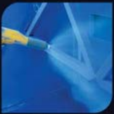
พ่นสีฝุ่นแบบกันยูวี UV Powder Coatings ด้วยมาตรฐานจาก JOTUN ทำให้ทนทานและสามารถติดตั้งงาน ภายนอกได้อย่างดี
