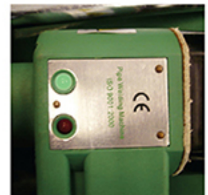
ไฟแดง แสดงถึงเครื่องยังไม่พร้อมใช้งาน ไฟเขียว แสดงถึงสามารถใช้งานได้แล้ว
