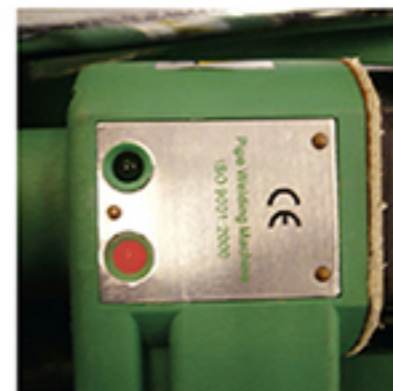
ไฟแดง แสดงถึงเครื่องยังไม่พร้อมใช้งาน ไฟเขียว แสดงถึงสามารถใช้งานได้แล้ว
