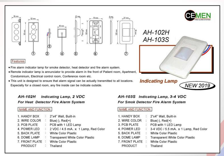
โคมไฟหน้าห้อง รุ่น AH-102H Indicating Lamp 2 VDC ใช้สำหรับต่อกับ Heat Detector โคมไฟหน้าห้อง รุ่น AH-103S Indicating Lamp 3-4 VDC ใช้สำหรับต่อกับ Smoke Detector
