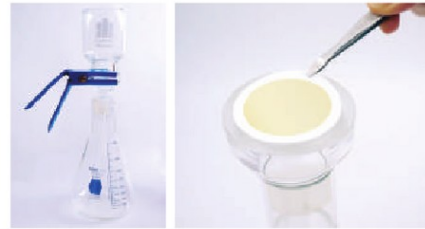
Kimble 사의 Funnel / Support ASSY 47mm with fritted glass 제품을 사용하여 여과 및 입자 제거, 포집이 가능합니다.
