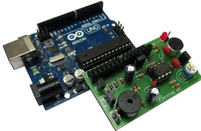
รูปที่ 9 แสดงการประกอบบอร์ดทดลอง FK1419 กับบอร์ด Arduino UNO R3
