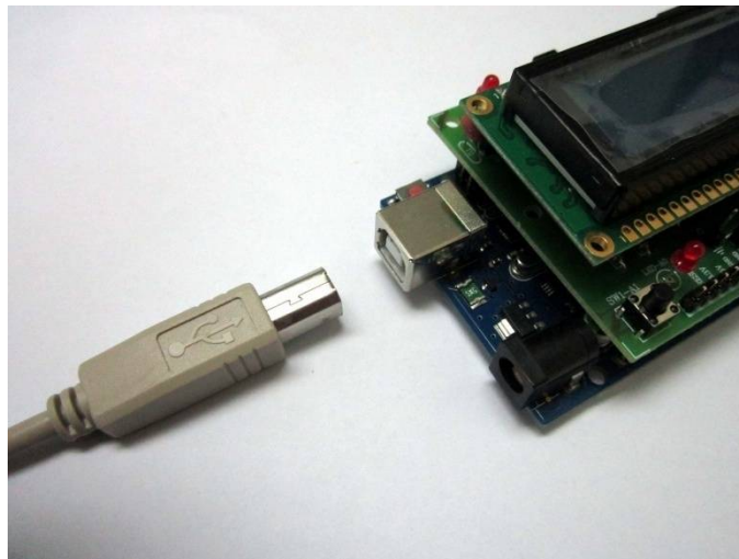
รูปที่ 10 แสดงการต่อสาย USB
