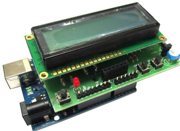
รูปที่ 9 แสดงการประกอบบอร์ดทดลอง FK1416 กับบอร์ด Arduino UNO R3
