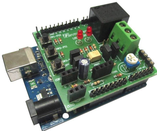
รูปที่ 9 แสดงการประกอบบอร์ดทดลอง FK1413 กับบอร์ด Arduino UNO R3
