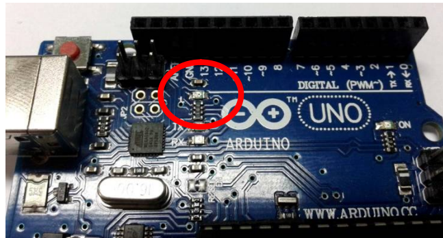
รูปที่ 8 แสดงตำแหน่ง LED L บนบอร์ด Arduino
