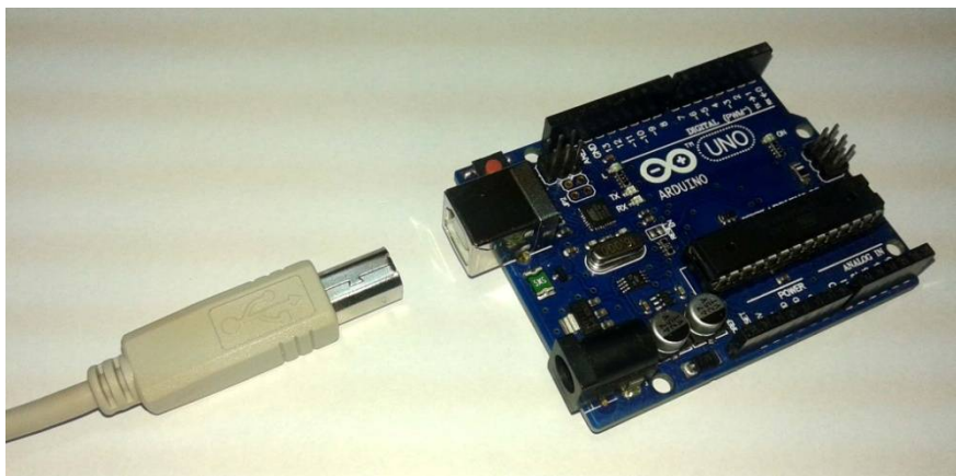
รูปที่ 4 แสดงการต่อสาย USB กับบอร์ด Arduino
