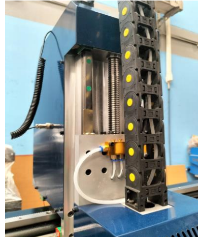
ชุดหัวแกน Z / บอลสกรูขึ้น-ลง/ กระบอกจ่ายน้ำมัน / กระจุกงูยัดหัว แกน Z
