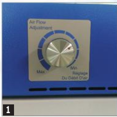
1 Fan speed controller
