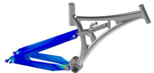
ผลของความเค้นในชุดประกอบเฟรม ของจักรยานเสือภูเขา
