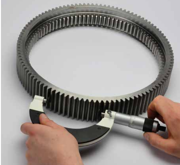
Abb. 1 – Zahnweitenmessung bei Außenverzahnung
