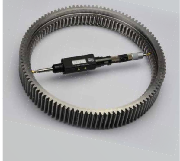
Abb. 2 – Messung des diametralen Zweikugelmaßes bei Innenverzahnung
