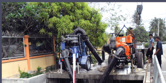
บิมน้ำเคลื่อนที่ แบบมีล้อลาก : TRAILER PUMPSET Horizontal Centrifugal Mixed Flow Pump
