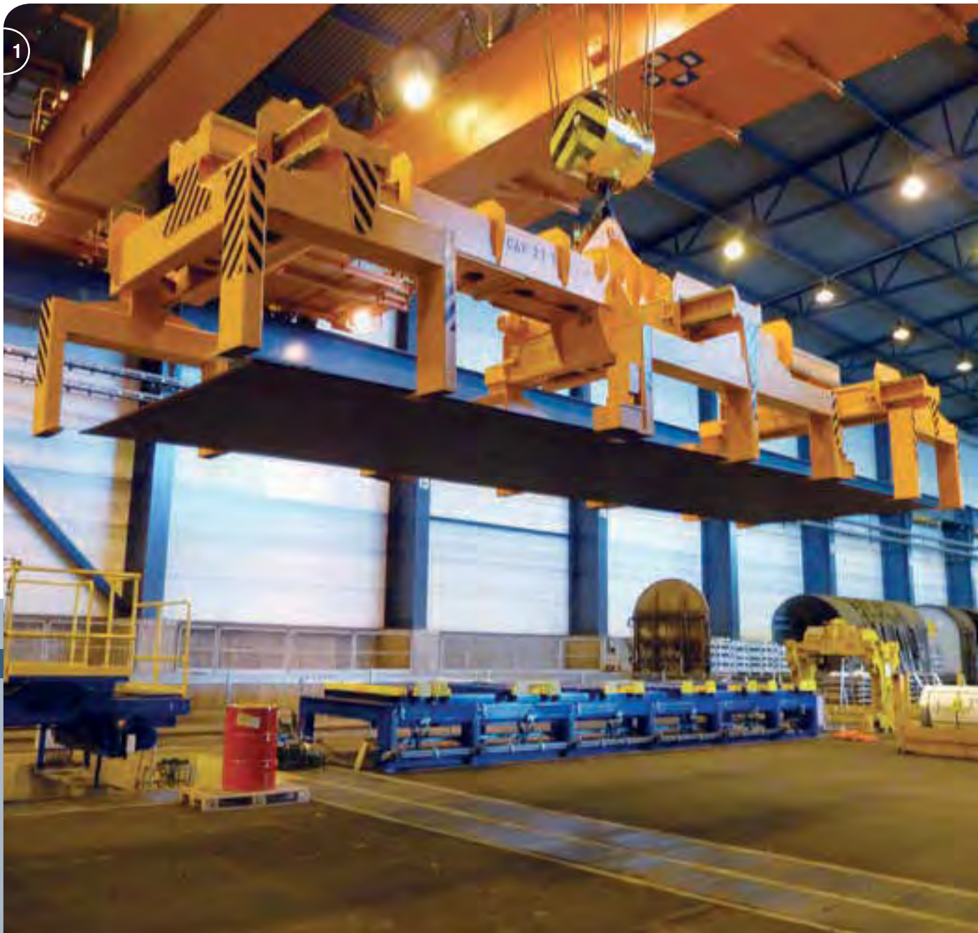
1 Elektromotorischer Blechpaketgreifer mit 27t Tragfähigkeit. Der Greifer ist in der Länge und in der Breite teleskopierbar und kann somit sehr unterschiedliche Stapel aufnehmen. Electromotive Sheet Stack Grab SWL 27t. Telescopic length and width adjustment for handling different sized stacks.
