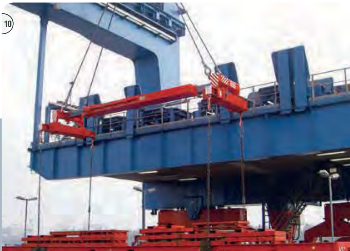
8 Elektromotorische Teleskoptraverse mit Zahnstangenantrieb.
