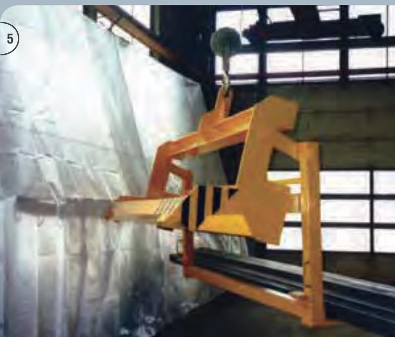
5 Regalgabel mit automatisch ausschwenkbarem Kontergewicht. Shelf Feeder with automatically movable counterweight.
