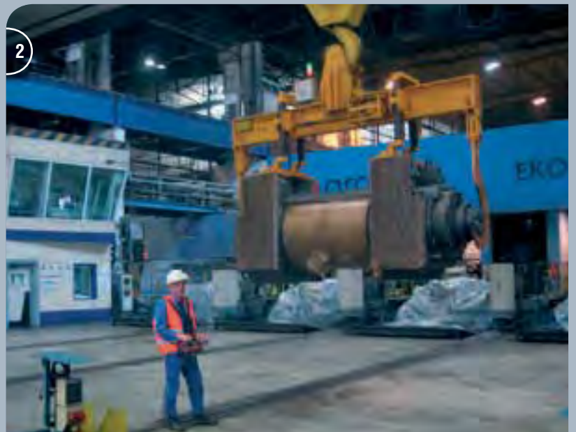
1-2 Elektromotorische Stützwälzentransporttraverse zum Greifen von Stützwälzen mit Baustücken. Electromotive roller transport crossheads for grabbing rollers with chocks.
