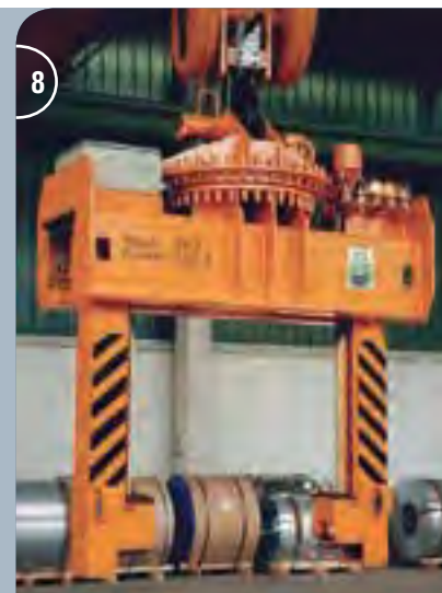
8 Elektromotorischer Teleskopcoilgreifer mit Horizontaldrehwerk, mit Lichtschranken zur Erfassung des Coillinnendurchmesser. Electromotive telescopic coil grab with horizontal slewing gear, with light barriers to detect the coils eye.
