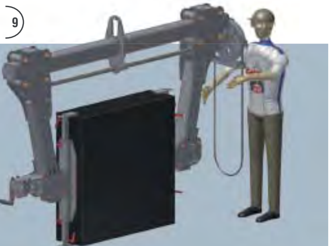
9 Spindelwendegreifer mit Haspelrad und Kette zum Öffnen und Schließen, sowie seitlichem Wendeantrieb über Handkurbel. Die schrägen Greifarme/Greifbacken sorgen für eine zusätzliche Klemmwirkung beim Anheben der Last. Zusätzlich verfügt der Greifer über Klappaschen an den Greifbacken zur Sicherung der Last gegen Herausrutschen.
