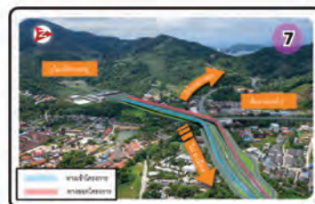
ทางแยกต่างระดับด้านกะทู้ เชื่อมต่อกับทางหลวงหมายเลข 4029 ในลักษณะ Directional Ramp ทิศทางเชื่อมตัวเมืองภูเก็ต Kathu Interchange Connecting to Highway 4029 in the form of a Directional Ramp, heading to Phuket City
