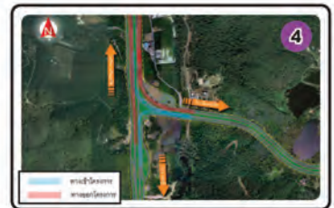
ทางแยกต่างระดับท่าหนึก 2 เชื่อมต่อกับระหว่างทางหลักและทางร่วมบรรจบเป็น System Interchange ออกแบบเป็น Y-Interchange Manik Interchange 2 Connection between the main line and the spur line make a system interchange. Y-Interchange is designed.
