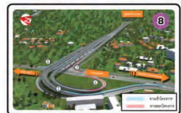
ทางแยกต่างระดับด้านป่าตอง เชื่อมต่อกับถนนพระเมตตา ออกแบบเป็น Trumpet Interchange Patong Interchange Connecting to Phra Metta Road in the form of a Trumpet Interchange.
