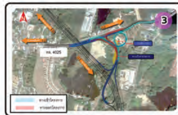
ทางแยกต่างระดับท่าหนึก 1 เชื่อมต่อกับทางหลวงหมายเลข 4025 ออกแบบเป็น Trumpet Interchange Manik Interchange 1 Connecting to Highway 4025 in the form of a Trumpet Interchange
