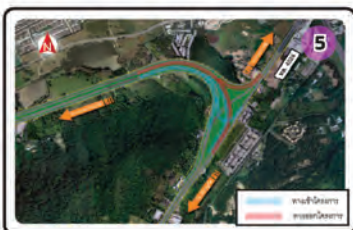
ทางแยกต่างระดับบางคู เชื่อมต่อกับทางหลวงหมายเลข 4024 (จุดสิ้นสุดทางร่วมบรรจบ) มีลักษณะเป็น Y-Interchange Bang Koo Interchange Connecting to Highway 4024 (Junction End) in the form of a Y-Interchange.
