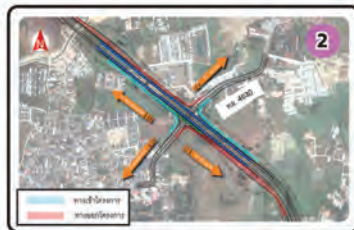
ทางแยกต่างระดับบ้านดอน เชื่อมต่อกับทางหลวงหมายเลข 4030 ออกแบบทางหลักเป็นสะพานข้ามทางหลวงหมายเลข 4030 Ban Don Interchange Connecting to Highway 4030, with the main line being a bridge over Highway 4030.
