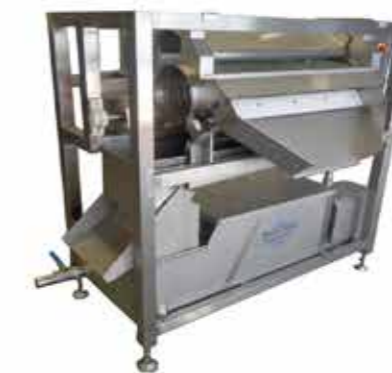
Rubbish Separator Machine เครื่องแยกเศษผม, พลาสติก
