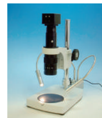
สามารถสังเกตวัตถุแบบสามมิติที่ชัดเจนได้ เนื่องจากการใช้แสงจากแขนทั้งด้านซ้ายและขวา
