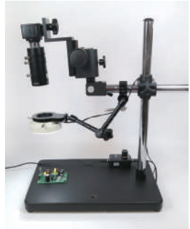
สามารถปรับตำแหน่งของไฟให้เข้ากับตำแหน่งเลนส์
