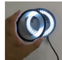
สามารถถอด-ใส่ไฟลเตอร์กระจายแสงได้
