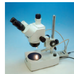
สามารถสังเกตวัตถุแบบสามมิติที่ชัดเจนได้ เนื่องจากการใช้แสงจากแขนทั้งด้านซ้ายและขวา
