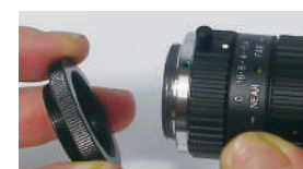
ติดตั้ง 5mm Close Up Ring ที่เลนส์โฟกัสคงที่
