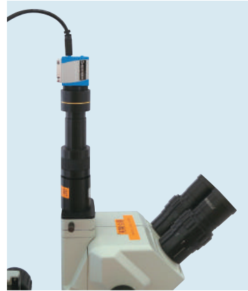
< การติดตั้งกล้องที่กระบอกตาที่สาม >
