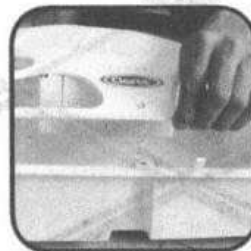
ขั้นที่ 3 : ดึงฝาล่างออกทำให้สามารถ ถอดชิ้นส่วนออกจากกันได้
