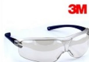
3M Virtua เลนส์ I/O (10436) สวมใส่ป้องกันดวงตาจากสะเก็ด และการกระเด็นของเศษวัสดุ เลนส์ผลิตจากวัสดุโพลีคาร์บอเนต Polycarbonate ป้องกันรังสี Ultraviolet ได้มากถึง 99.9% เลนส์เคลือบ Anti Fog ขาแว่นปรับความยาวได้ 3 ตำแหน่ง Standard : ANSI Z87.1-2003
