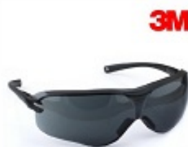
3M Virtua เลนส์ดำ (10435) สวมใส่ป้องกันดวงตาจากสะเก็ด และการกระเด็นของเศษวัสดุ เลนส์ผลิตจากวัสดุโพลีคาร์บอเนต Polycarbonate ป้องกันรังสี Ultraviolet ได้มากถึง 99.9% เลนส์เคลือบ Anti Fog ขาแว่นปรับความยาวได้ 3 ตำแหน่ง Standard : ANSI Z87.1-2003
