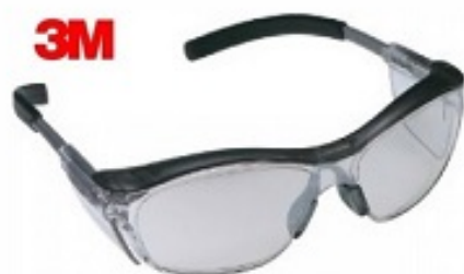
3M nuvo เลนส์ I/O (11519) สวมใส่ป้องกันดวงตาจากสะเก็ด และการกระเด็นของเศษวัสดุ เลนส์ผลิตจากวัสดุโพลีคาร์บอเนต Polycarbonate ป้องกันรังสี Ultraviolet ได้มากถึง 99.9% เลนส์เคลือบ Anti Fog ขาแว่นปรับความยาวได้ 3 ตำแหน่ง Standard : ANSI Z87.1-2003
