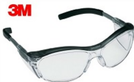
3M nuvo เลนส์ใส (11411) สวมใส่ป้องกันดวงตาจากสะเก็ด และการกระเด็นของเศษวัสดุ เลนส์ผลิตจากวัสดุโพลีคาร์บอเนต Polycarbonate ป้องกันรังสี Ultraviolet ได้มากถึง 99.9% เลนส์เคลือบ Anti Fog ขาแว่นปรับความยาวได้ 3 ตำแหน่ง Standard : ANSI Z87.1-2003
