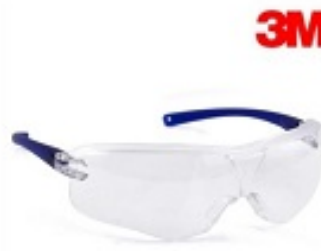
3M Virtua เลนส์ใส (10434) สวมใส่ป้องกันดวงตาจากสะเก็ด และการกระเด็นของเศษวัสดุ เลนส์ผลิตจากวัสดุโพลีคาร์บอเนต Polycarbonate ป้องกันรังสี Ultraviolet ได้มากถึง 99.9% เลนส์เคลือบ Anti Fog ขาแว่นปรับความยาวได้ 3 ตำแหน่ง Standard : ANSI Z87.1-2003
